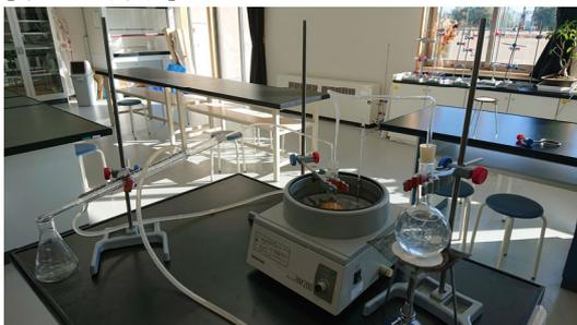
【水蒸気蒸留の実験】
